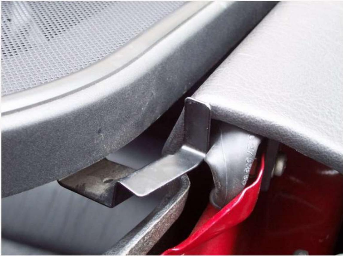
**Mauvais montage :** (la patte est rentrée sous l'accoudoir et glisse ce qui a pour conséquence de ne plus exercer de tension sur la patte qui se glisse au niveau de la ceinture de sécurité)
