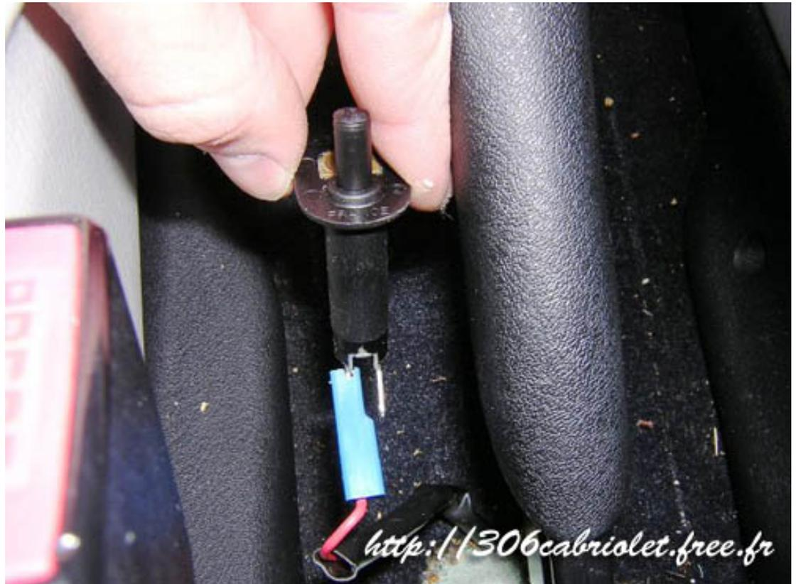
Maintenant l'opération consiste à brancher la fil qui ira jusqu'au connecteur. Pour cela il faut prévoir une cosse et une pince à sertir. Pour ma part j'ai directement mis le fil d'origine ( rouge ) avec le nouveau fil ( Blanc ). Il est également possible d'utiliser l'autre patte libre et d'y glisser votre bout de fil sans rien démonter ni couper sur le fil d'origine.
