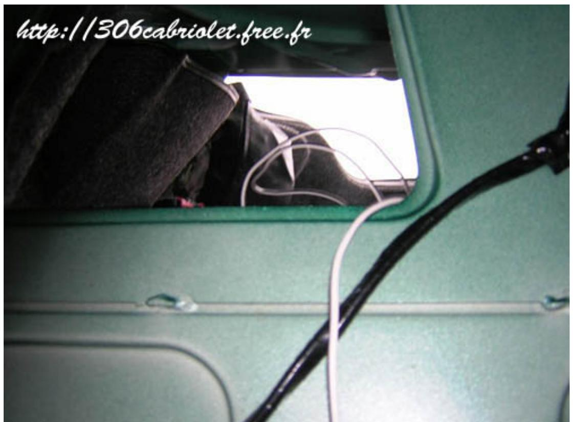
Dans le coffre vous le passez derrière la moquette qui se trouve sur le côté droit jusqu'au calculateur.
