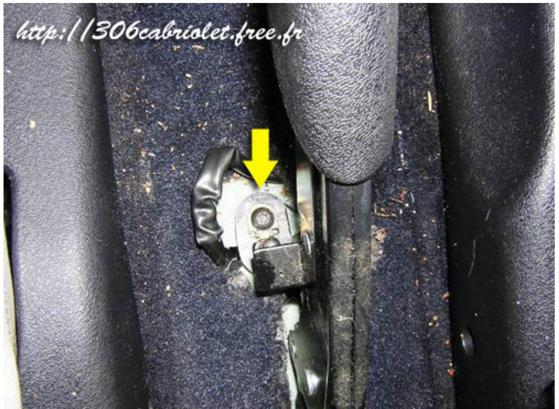
Ensuite vous tirez le frein à main à fond pour pouvoir démonter cette interrupteur, il est maintenue qu'avec une vis torque. Une fois la vis enlever tirez dessus doucement.
