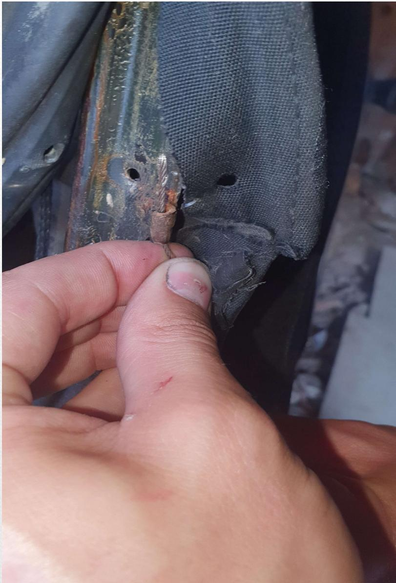
Passez le bout du câble dans son emplacement sur l'armature (en ayant préalablement retiré l'ancien bout de câble si il y était encore)
