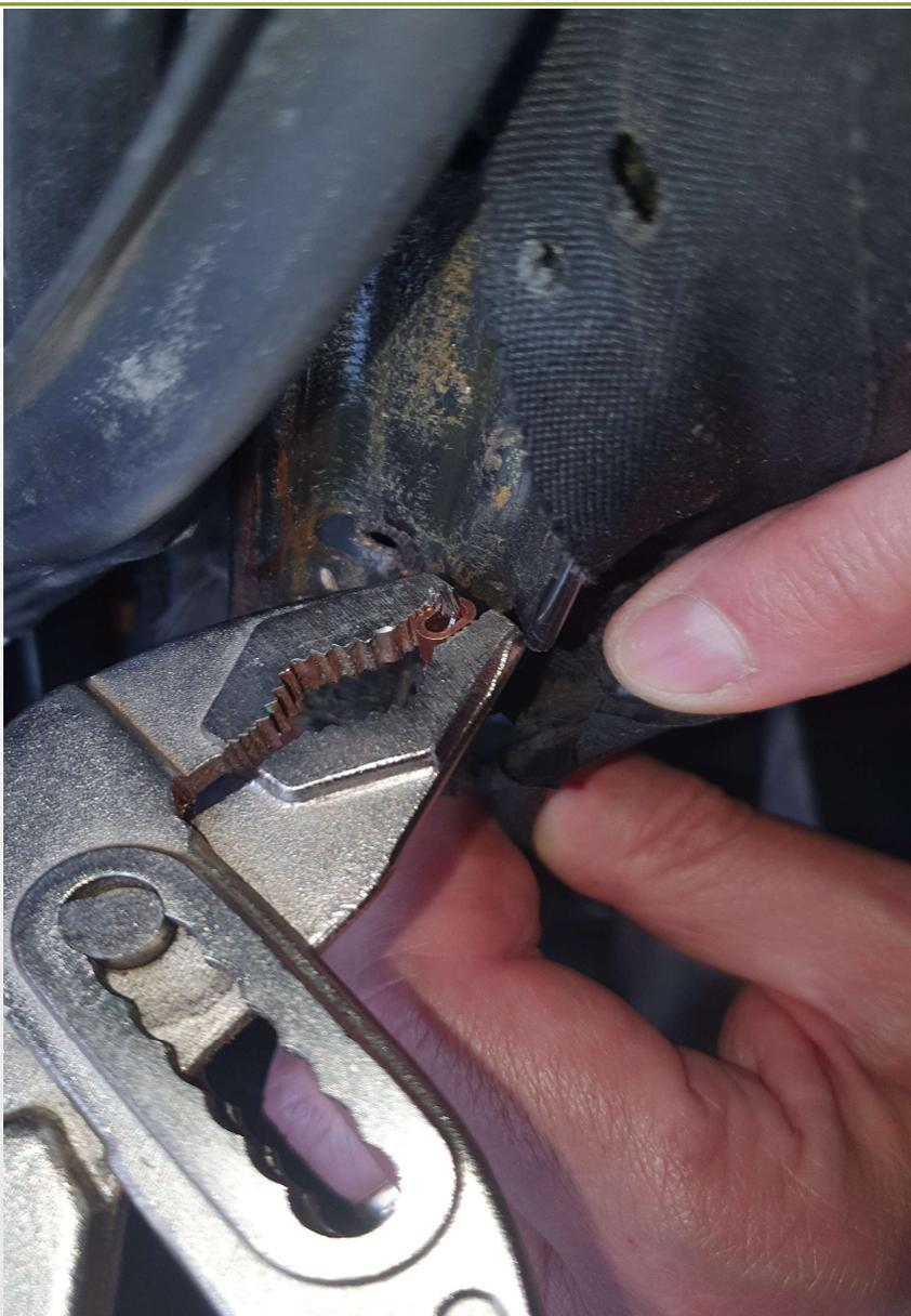
Y insérer la bague en cuivre et l'aplatir
